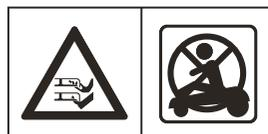
**ПРЕДУПРЕЖДЕНИЕ:** Запрещается передвигаться на агрегате. Запрещается держать руки или ноги вблизи корпуса или засовывать их под корпус газонокосилки.
