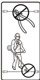
Запрещается укорачивать, удлинять или наращивать кабель низкого напряжения.
