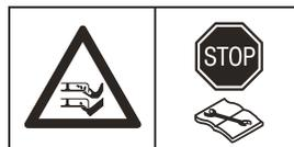
**ПРЕДУПРЕЖДЕНИЕ:** Перед выполнением каких-либо операций с газонокосилкой или ее подъемом закройте устройство отключения.
