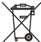
Данный символ на газонокосилке-роботе GARDENA означает, что данное изделие не подлежит утилизации в качестве бытовых отходов. Устройство следует передать в соответствующий центр приемки, где будет произведена утилизация электронных компонентов и аккумуляторов. Перед утилизацией изделия из него следует извлечь аккумулятор.
